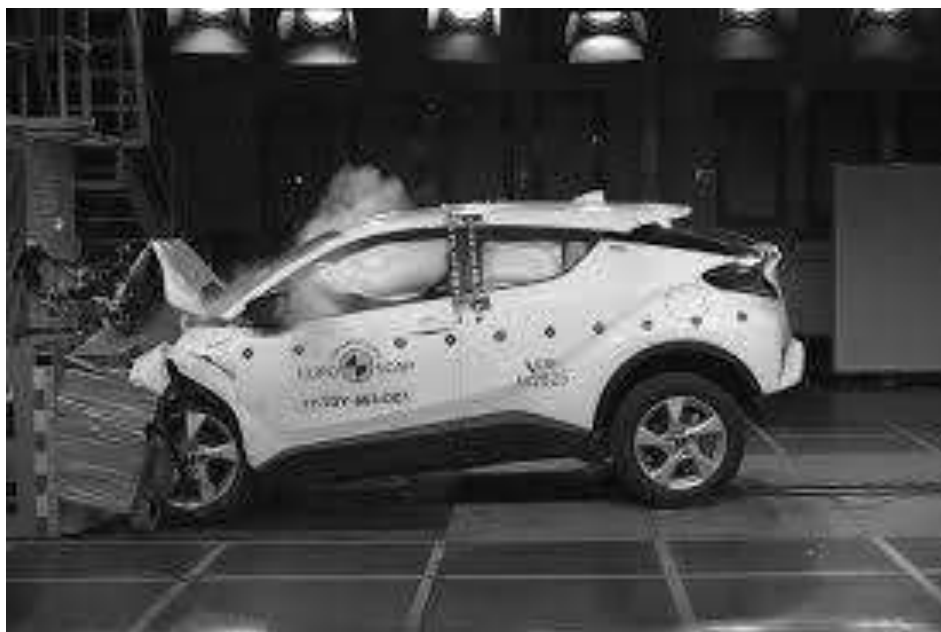
Рис 2. Специальные дополнительные испытания автомобиля по более жесткой программе Euro NCAP с отдельной оценкой безопасности водителя, пассажиров, детей и пешеходов
